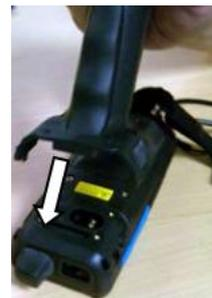
5. 6 個の取り付けネジでガングリップを取り付けます。取り付けネジをカバーするためにネジ保護パッドを差し込みます。
