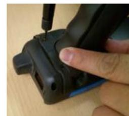
6. 下の図は、PA690 モバイルコンピュータにガングリップが取り付けられた状態を示しています。
