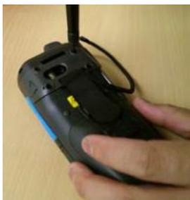
3. バックプレートからシールドを外します(以下参照)。
