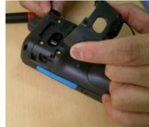
4. ガングリップの取り付け穴を PA690 背面のネジ穴に合わせます。ガングリップを押し下げると、PA690 の背面にぴったりと合います。ガングリップトリガは、PA690 アンテナと同じ方向に向いていなければなりません。
