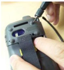
2. ネジ保護パッドの下の 6 個のネジを外します。
