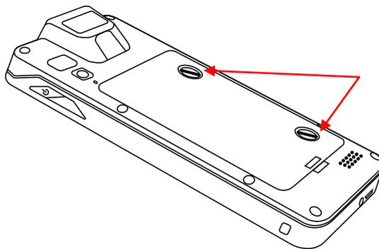
2つのネジをコインや工具を使って左向きに回します。
