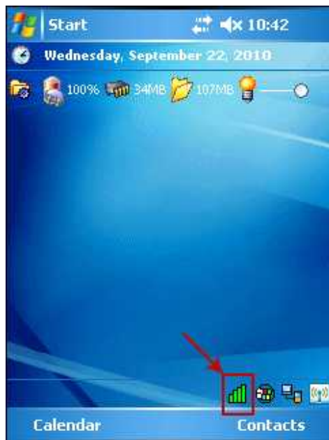
図 6: Summit System Tray ウィンドウ 注:SCU を起動するにはアイコンをタップします 以下の条件下でのみ SCU サービスは動作し、アイコンが表示されます。
